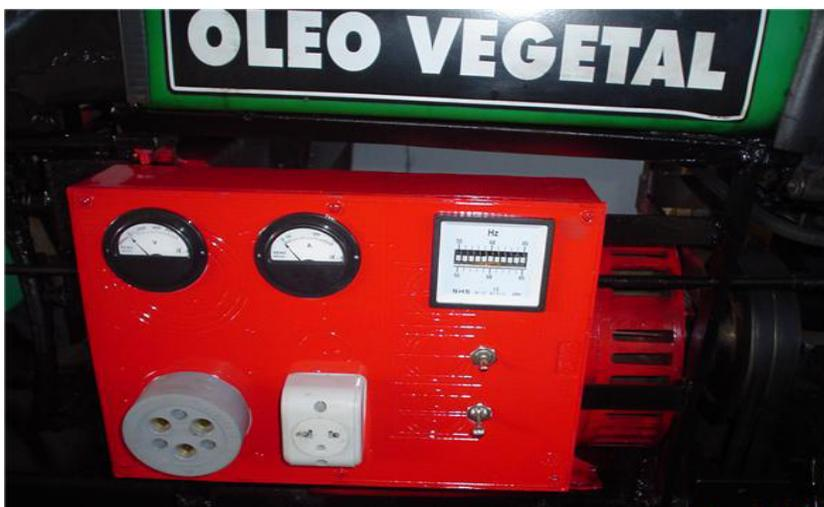
Fotografia 1: Painel de controle e gerador de energia elétrica, integrado à polia do motor, alimentado por óleo vegetal puro.
