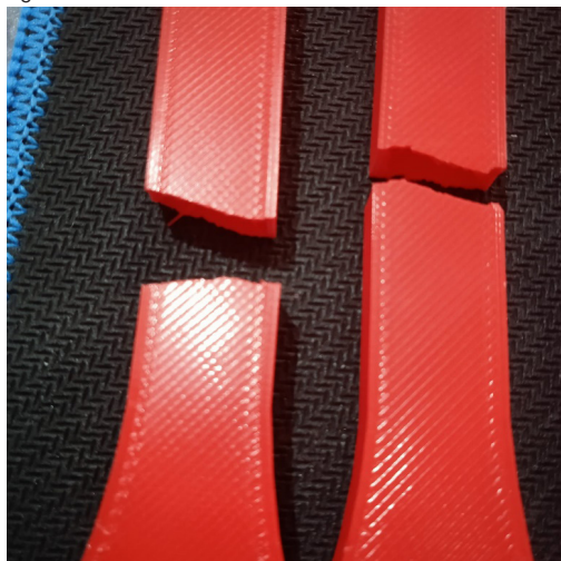
Figura 1 – Fratura dúctil na amostra de PLA.
