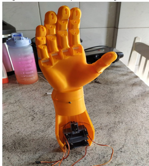
Fotografia 3 – Mão biônica impressa em tecnologia 3D
