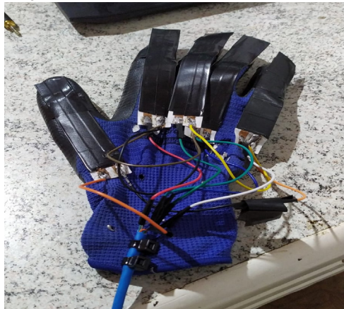
Fotografia 2 – Luva controladora com sensores flexíveis
