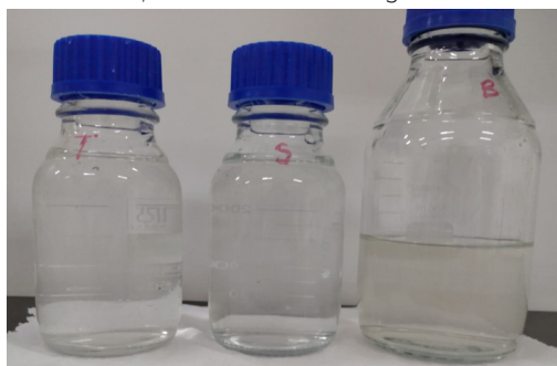
Fotografia 2 - Amostras de água tratadas com Tanfloc SG, sulfato de alumínio e água bruta
