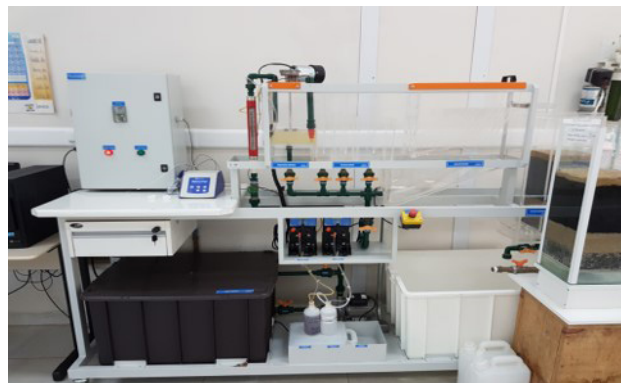
Figura 1 – Bancada de tratamento de água
