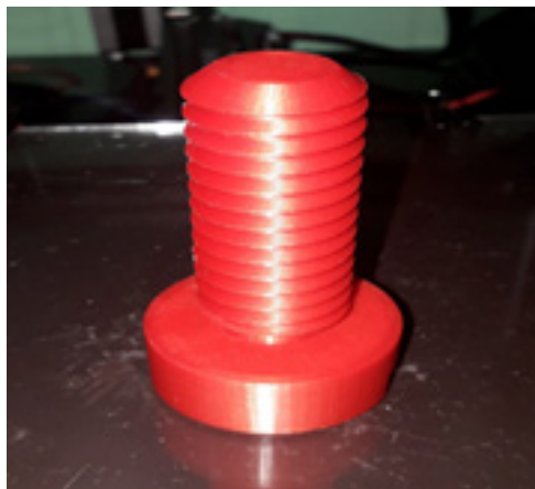
Figura 2 – Parafuso obtido com a impressora 3D
