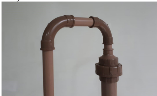
Fotografia 5 – Conexões na saída da coluna de leito fixo
