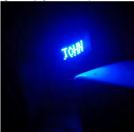
Figura 9 - Display Pov em execução com o texto "JOHN"
