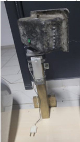
Figura 7- Estrutura: Display POV
