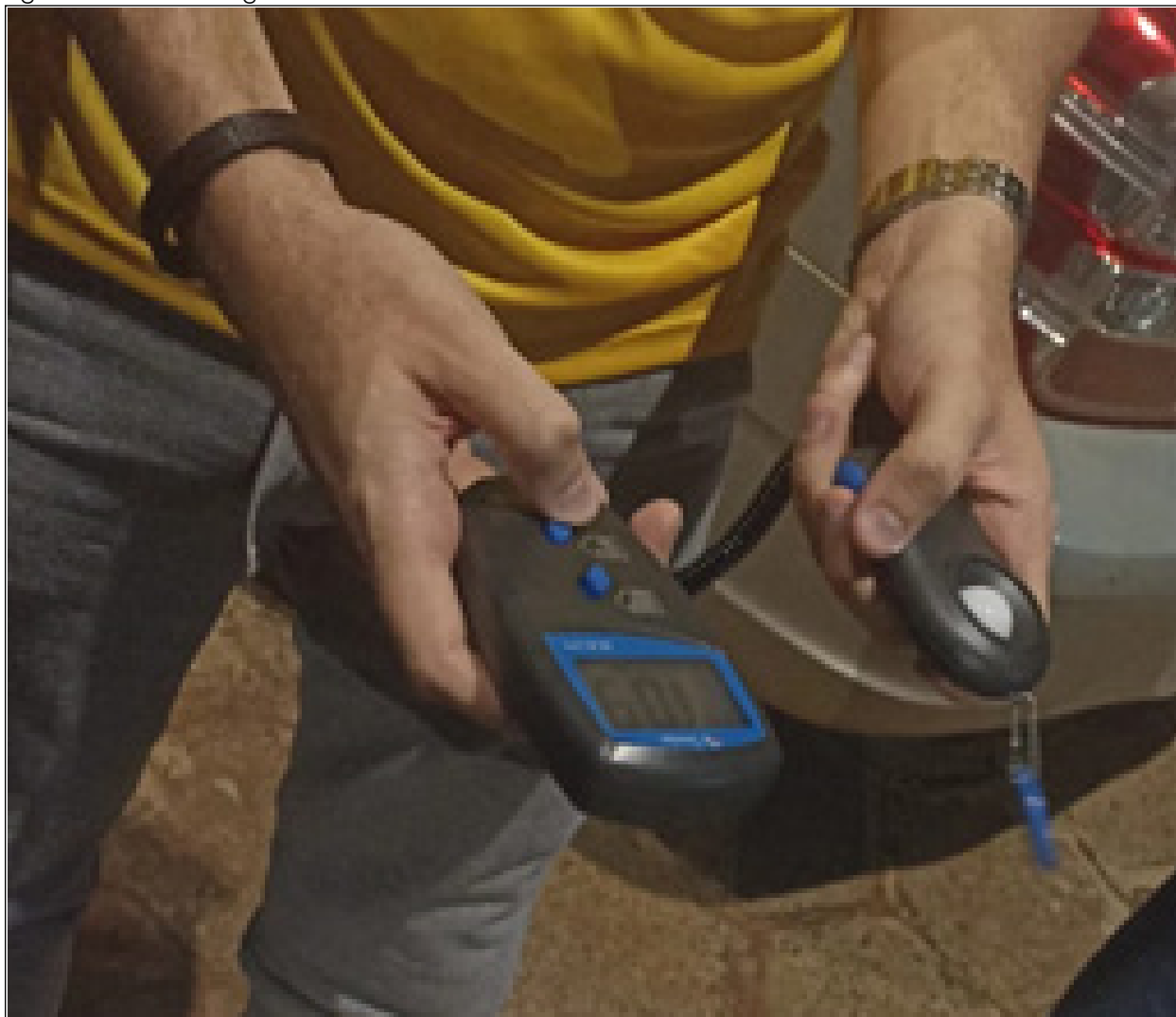
Figura 2 - Luxímetro digital MLM-1011
