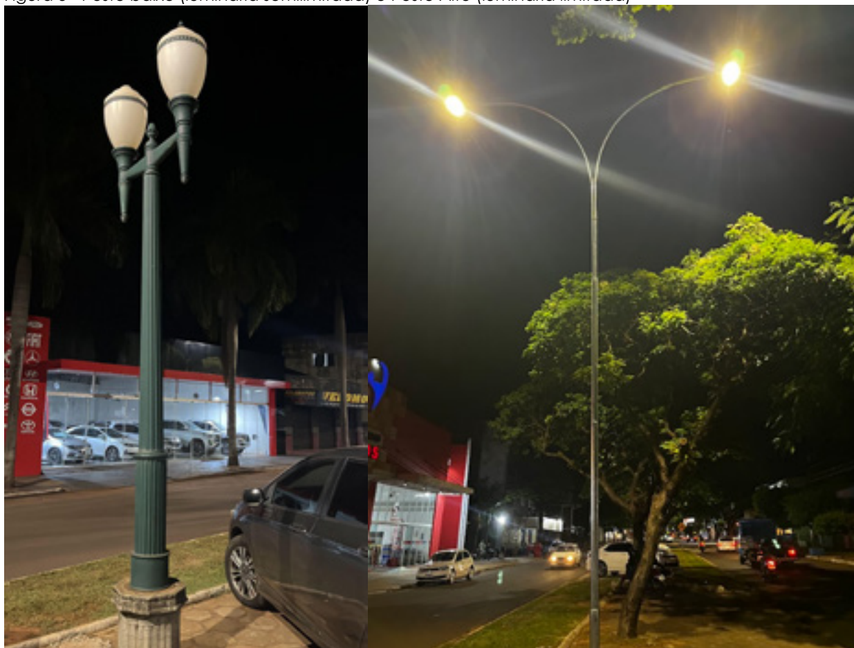
Figura 5 - Poste baixo (luminária semilimitada) e Poste Alto (luminária limitada)
