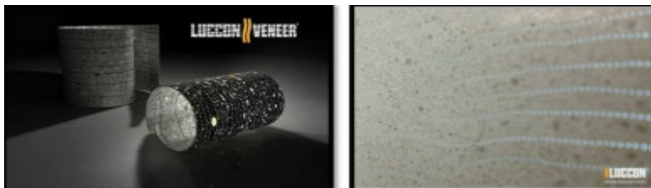
FIGURA 6: Concreto translúcido produzido pela empresa Lucon Veneer (2009).
