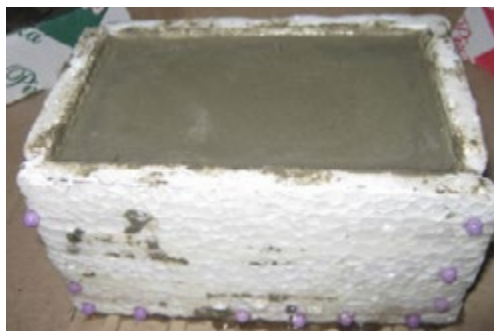
IMAGEM 9: Forma de isopor com concreto e fibras óticas.
