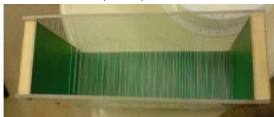
FIGURA 3: Fibras ópticas posicionadas na fôrma.
