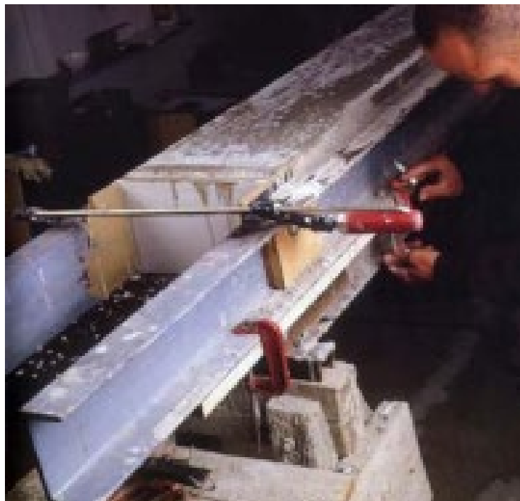
FIGURA 1: Molde concreto com fibra óptica.
