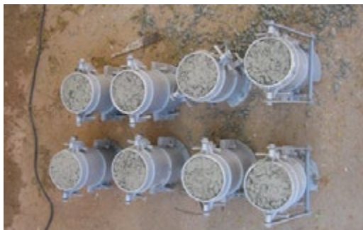
FIGURA 2: Moldagem dos corpos de prova.
