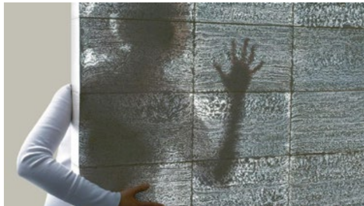
FIGURA 5: Concreto translúcido produzido pela empresa Litricon.
