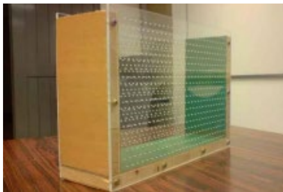
FIGURA 2: Fôrma usada para a fabricação do bloco de concreto translúcido.
