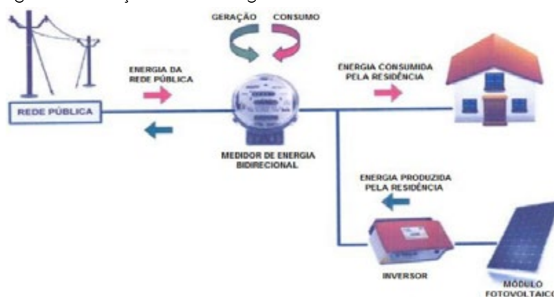
Figura 2. Instalação Net Metering.
