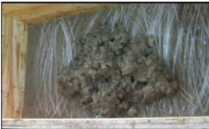
FIGURA 8: Fibras óticas e argamassa colocadas uma acima da outra.
