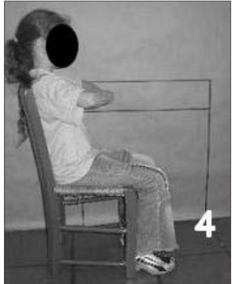
Fotografia 4: Postura da aluna de 1ª série, com sete anos, na simulação do mobiliário intermediário sugerido no Quadro 2
