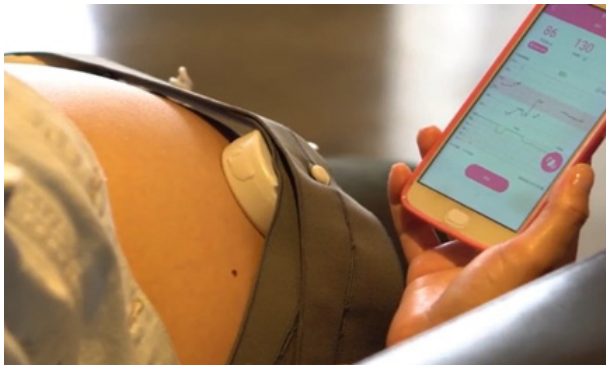
Figura 2 - Monitor de cardiocógrafa fetal portátil da ShenZhen Luckhome Technology Inc Ltda (China) – modelo eFM60 afixado por cinta de tecido no abdome de uma gestante
