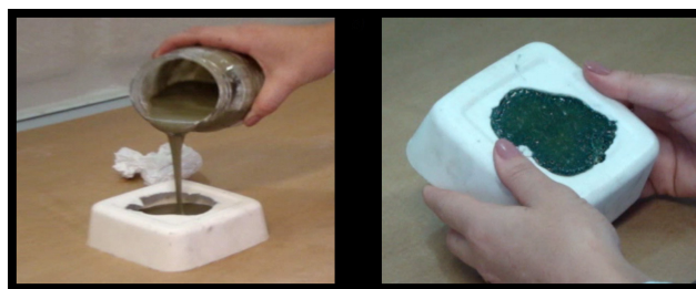
Figura 3 – Despejo da resina de poliéster ainda líquida, no molde de silicone (A) e a réplica em resina de poliéster pronta, após 24 horas (B).
