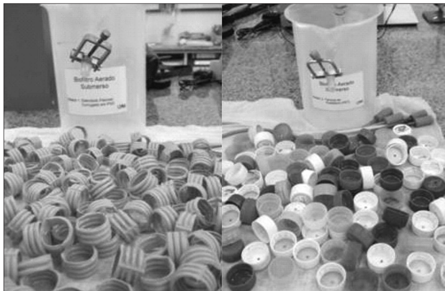
Fotografia 2: Materiais utilizados na montagem dos reatores
