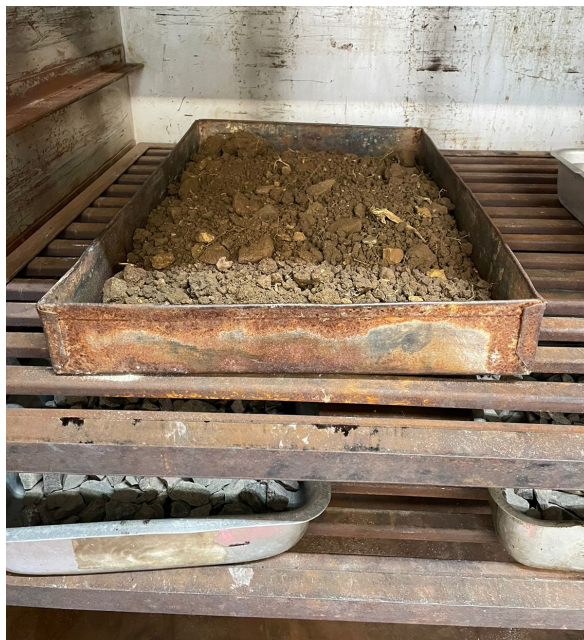
Fotografia 1 – Amostra secando em estufa a 100°
