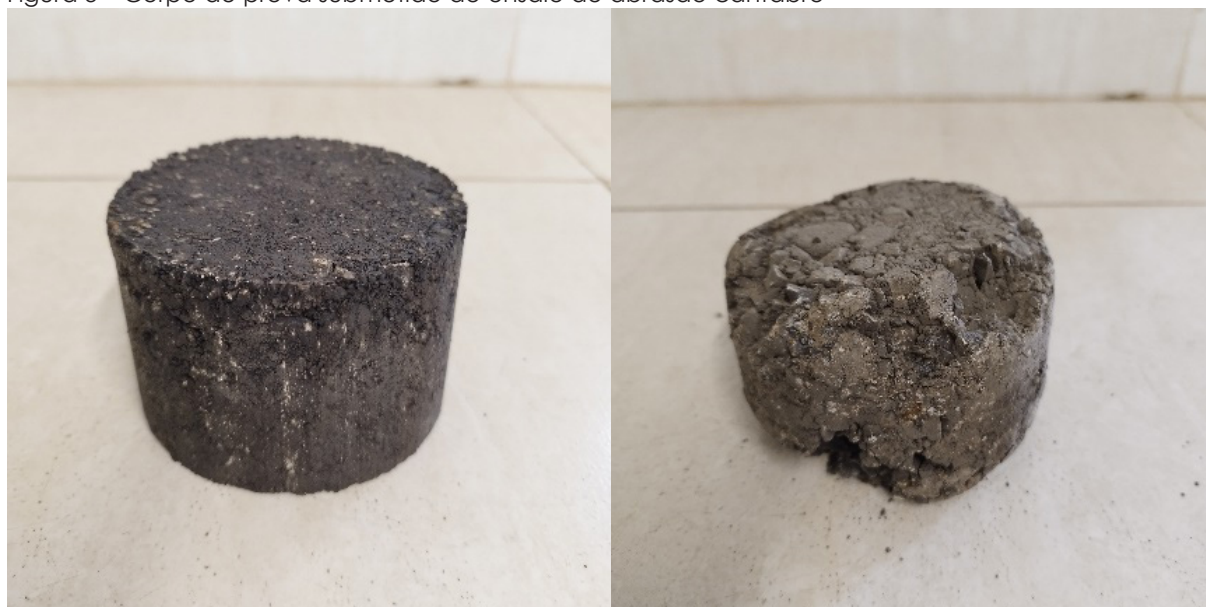
Figura 3 – Corpo de prova submetido ao ensaio de abrasão cântabro
