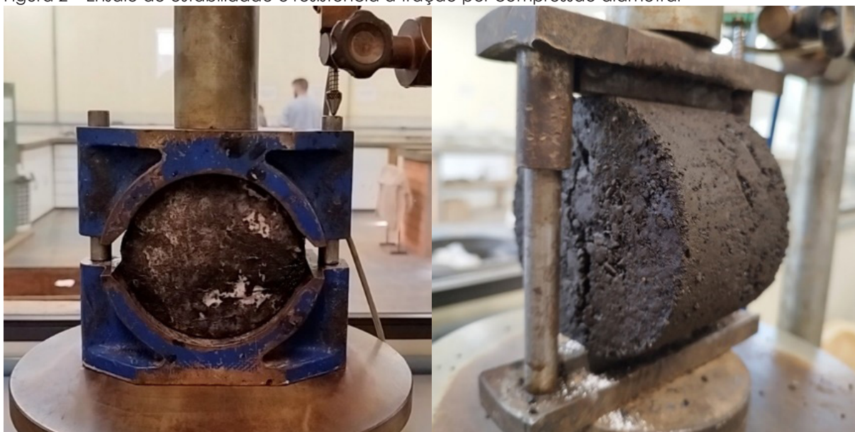
Figura 2 – Ensaio de estabilidade e resistência à tração por compressão diametral
