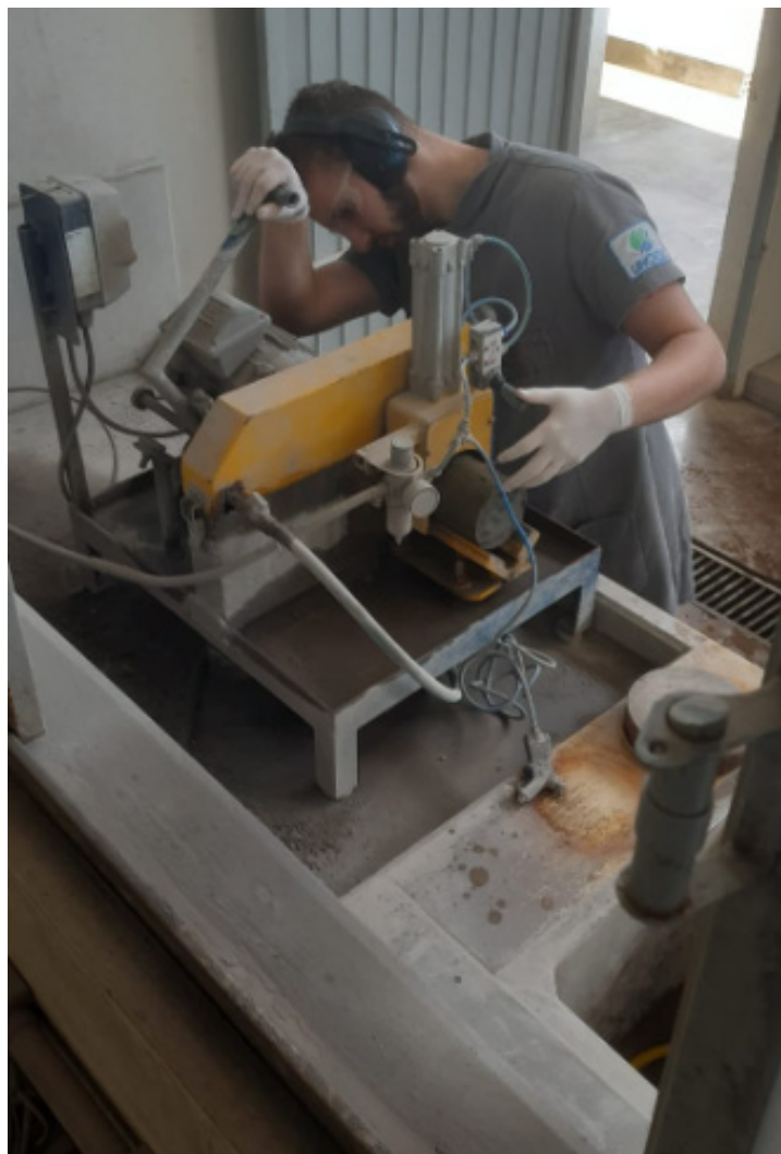
Fotografia 10 – Processo de Retificação dos Corpos de Provas
