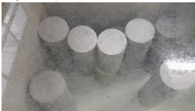
Fotografia 5 – Corpos de Prova em Cura Úmida
