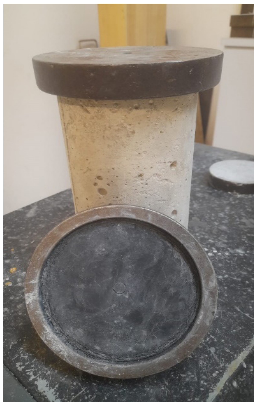
Fotografia 13 – Rompimento do Corpo com Borracha de Neoprene
