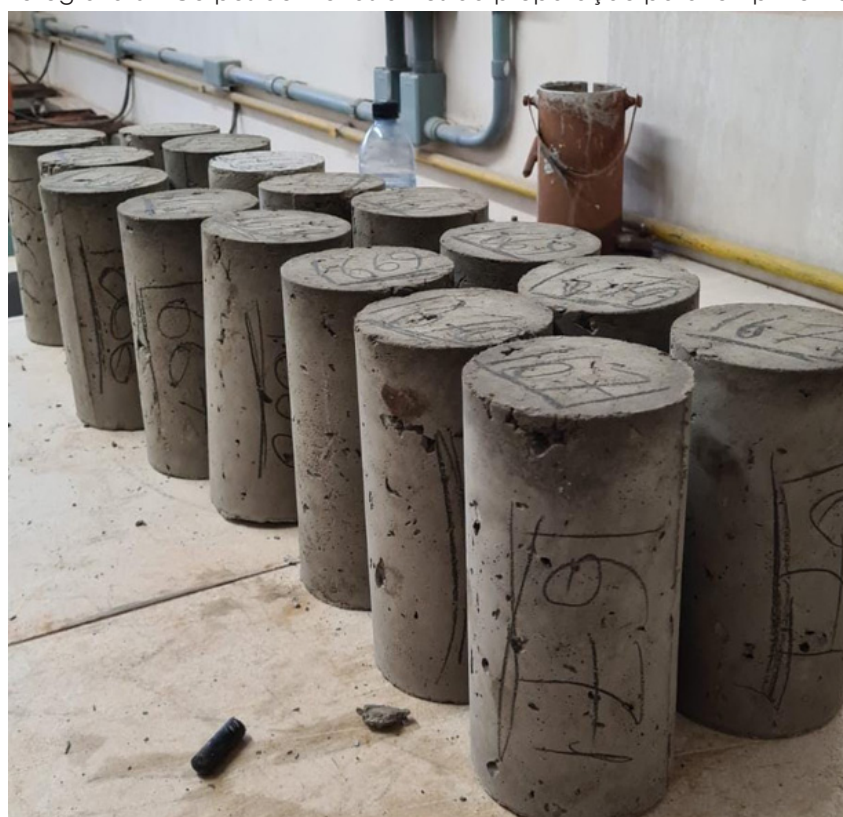
Fotografia 6 – Corpos de Provas antes da preparação para rompimento.
