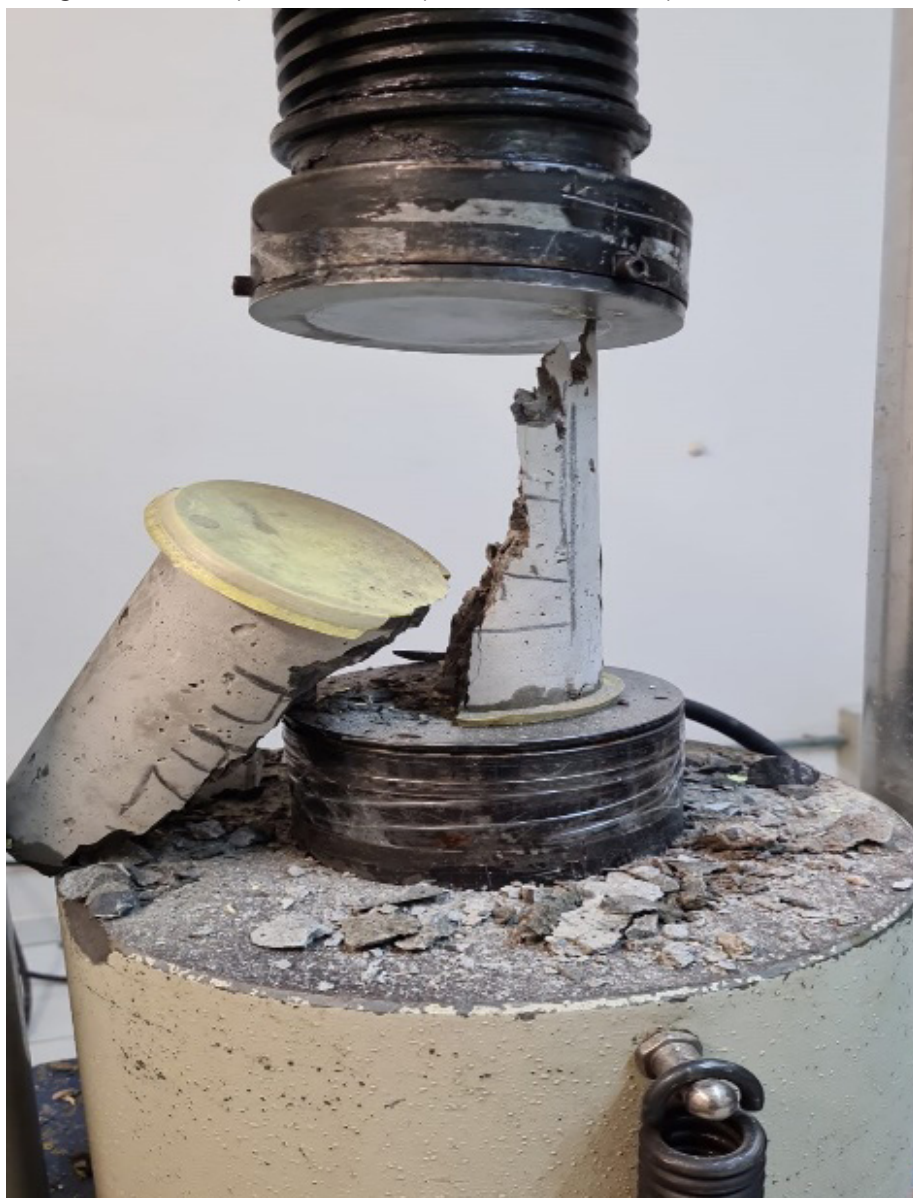
Fotografia 11 – Rompimento do Corpo de Prova com capeamento de enxofre
