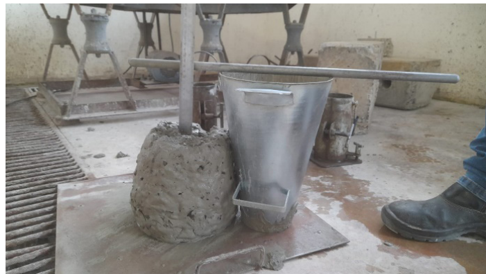
Fotografia 7 – Ensaio de Abatimento de Cone
