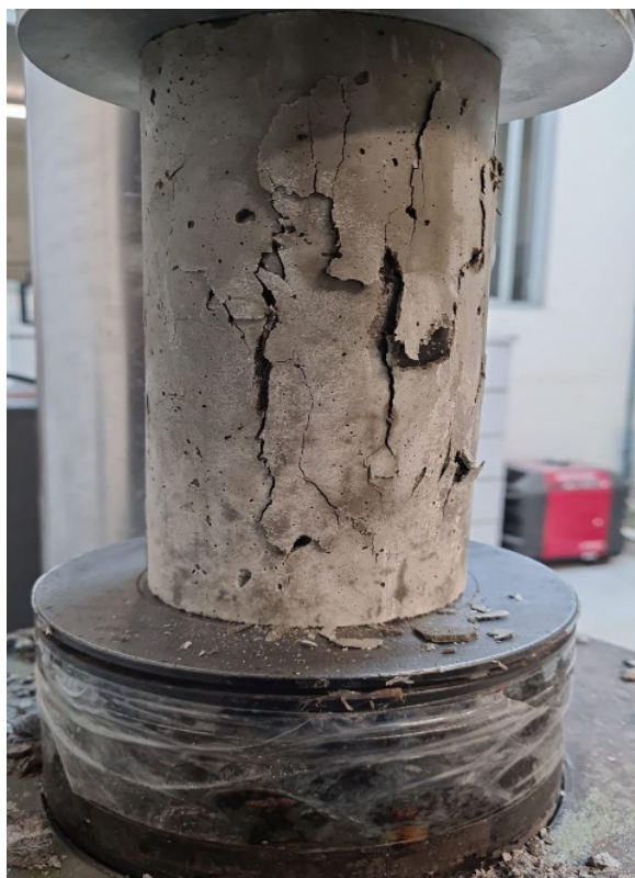
Fotografia 12 – Rompimento do Corpo de Prova por Retifica
