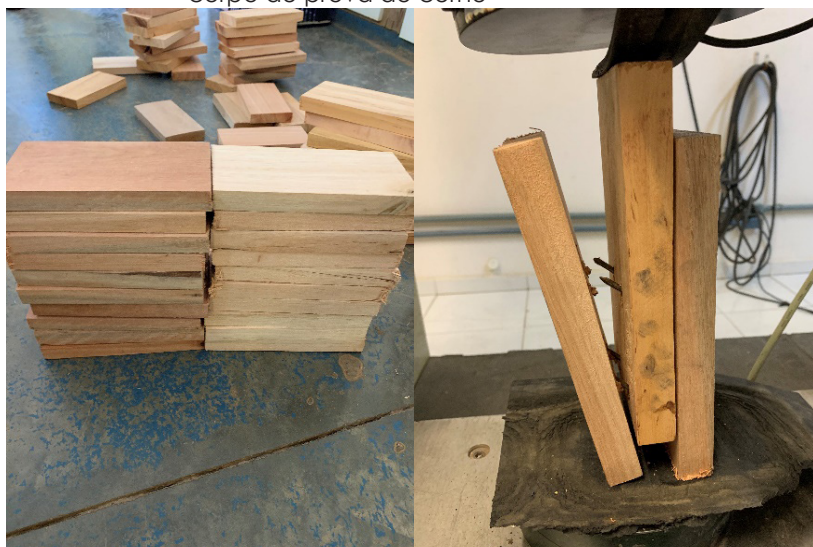
Figuras 14 e 15: Material utilizado para as ligações e rompimento de corpo de prova do cerne
