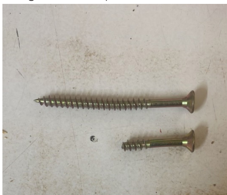
Fotografia 15: rompimento do CP P1-6
