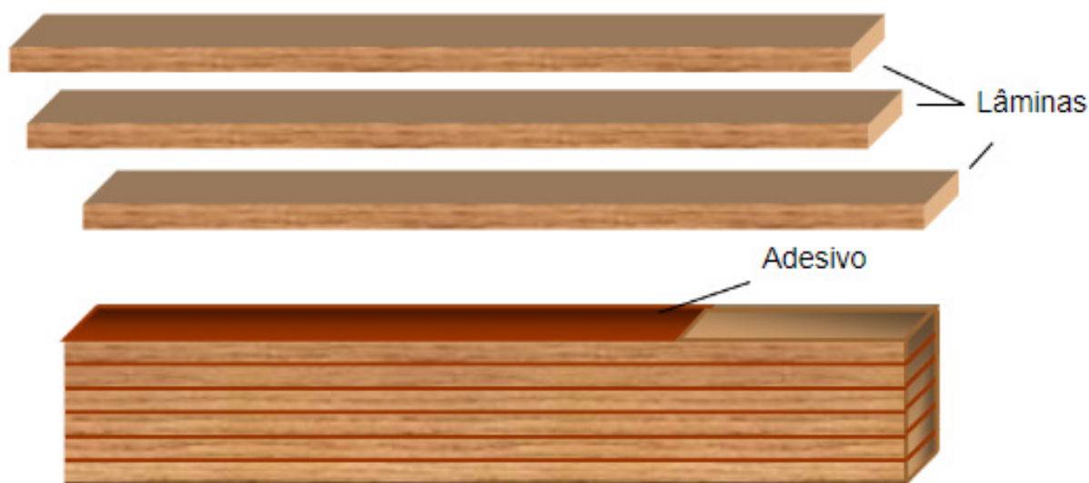
Figura 1 –Esquema de uma viga de MLC
