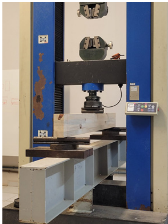
Fotografia 2 – Ensaio a flexão em três pontos
