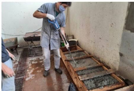
Fotografia 2 - Moldagem e adensamento da placa
