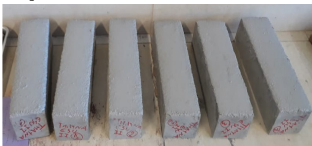
Fotografia 4 - Prismas de concreto com revestimento
