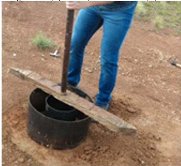
Fotografia 2 - (a) Cravação dos anéis e (b) Ensaio dos anéis
