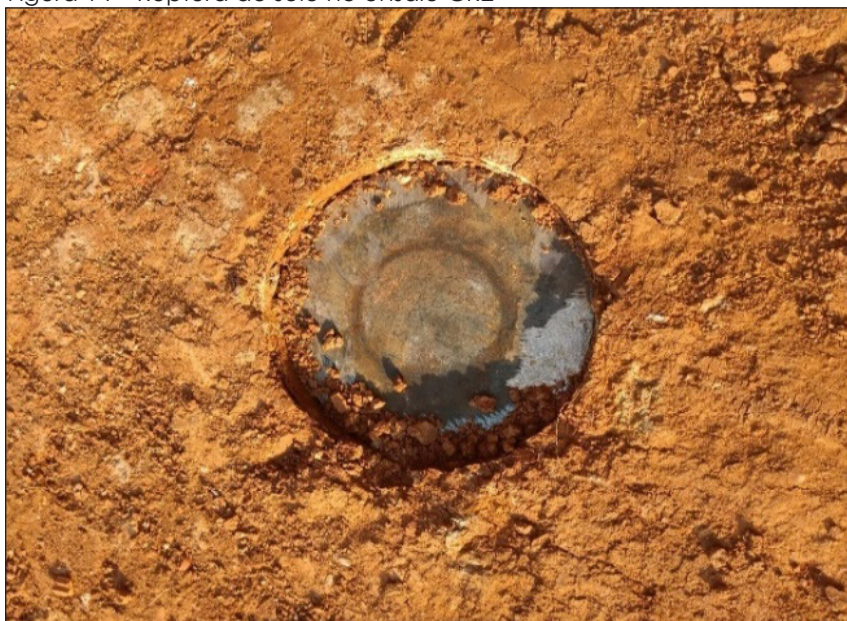
Figura 14 – Ruptura do solo no ensaio CR2
