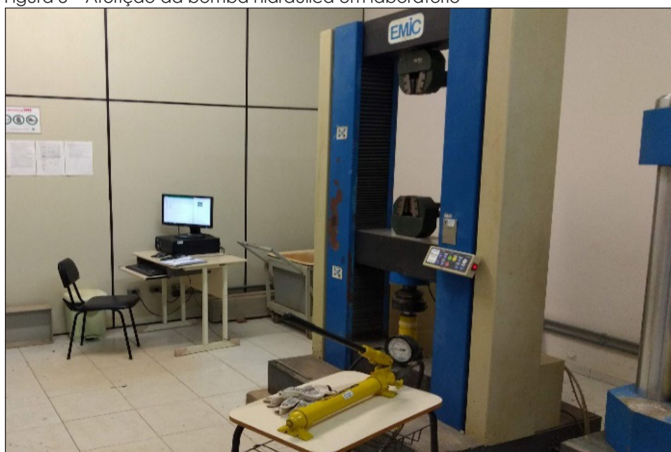
Figura 8 – Aferição da bomba hidráulica em laboratório
