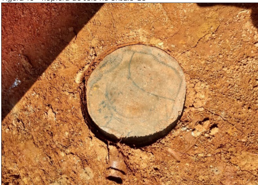
Figura 15 – Ruptura do solo no ensaio CL
