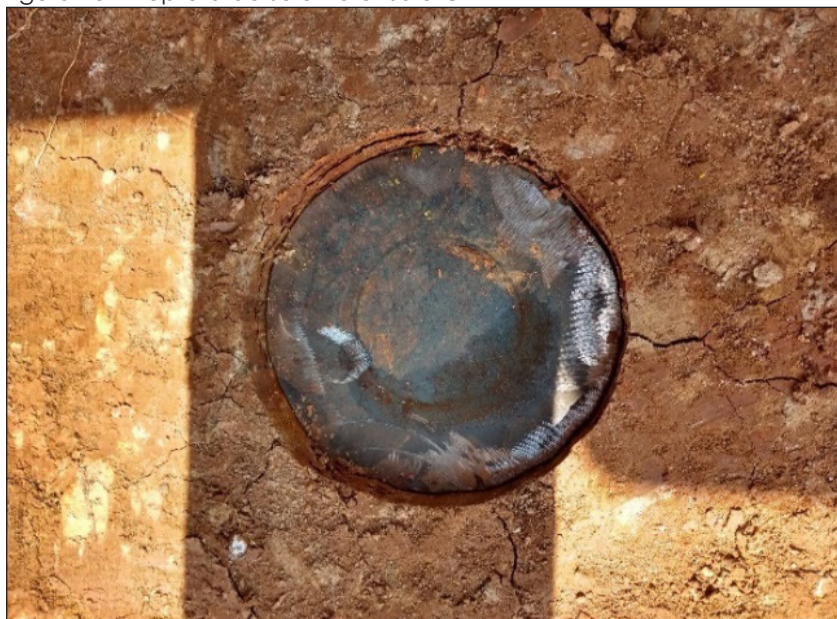
Figura 13 – Ruptura do solo no ensaio CR1
