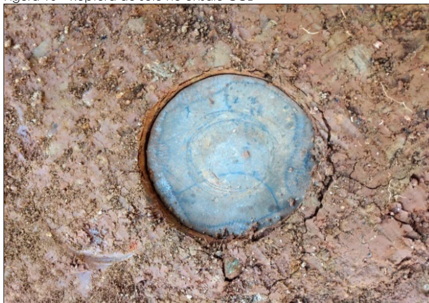
Figura 16 – Ruptura do solo no ensaio CCL
