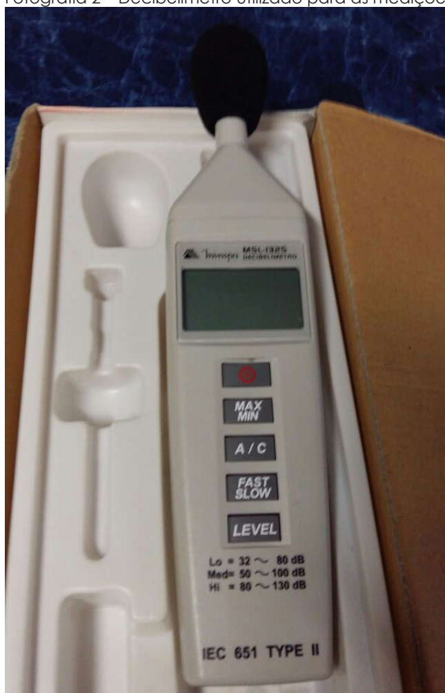
Fotografia 2 – Decibelímetro utilizado para as medições
