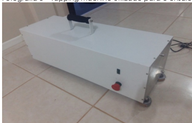
Fotografia 3 – Tapping Machine utilizado para o ensaio
