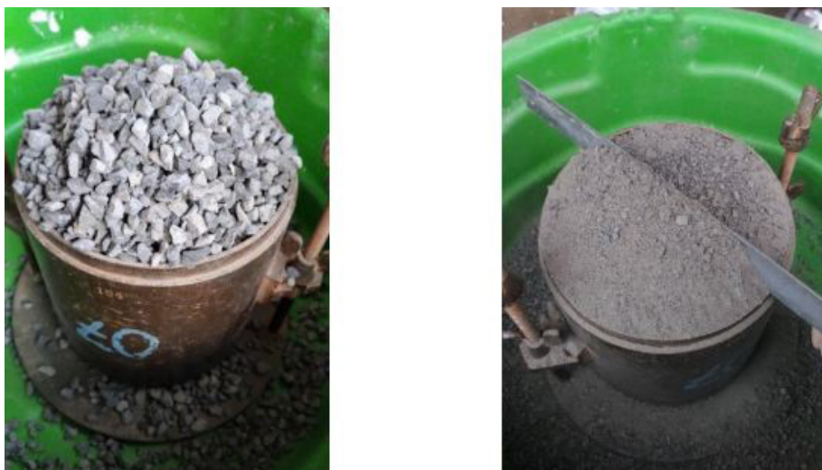
Fotografia 3 – Ensaio de massa unitária dos agregados graúdos e miúdos
