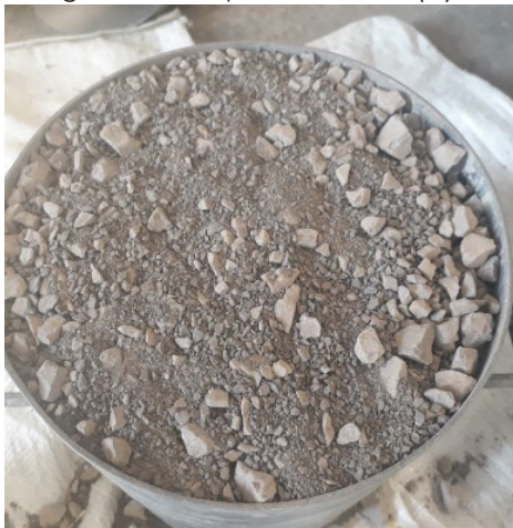
Fotografia 1 – Empacotamento (a) com adição de pó de pedra; (b) com adição de areia natural
