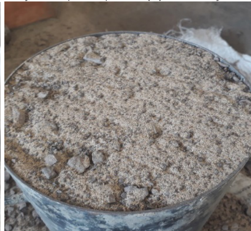
Fotografia 1 – Empacotamento (a) com adição de pó de pedra; (b) com adição de areia natural
