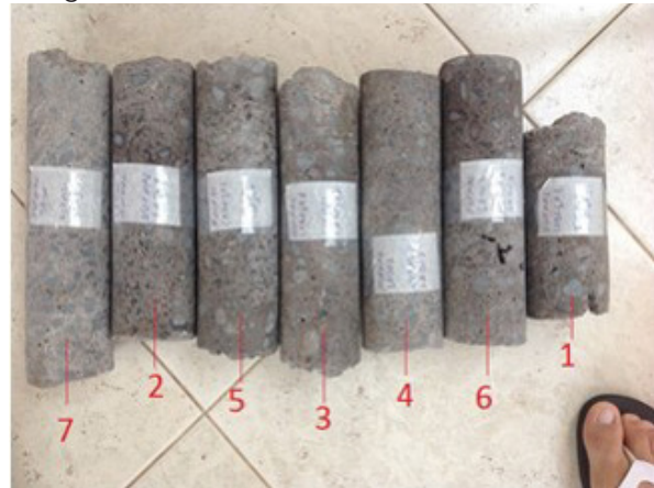
Fotografia 3 – Amostras de concreto extraídas de T1
