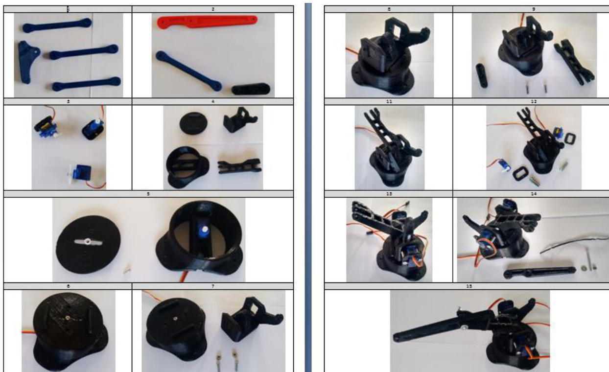
Imagem 2 – Conjunto contendo as partes de um guindaste, impresso em 3D
