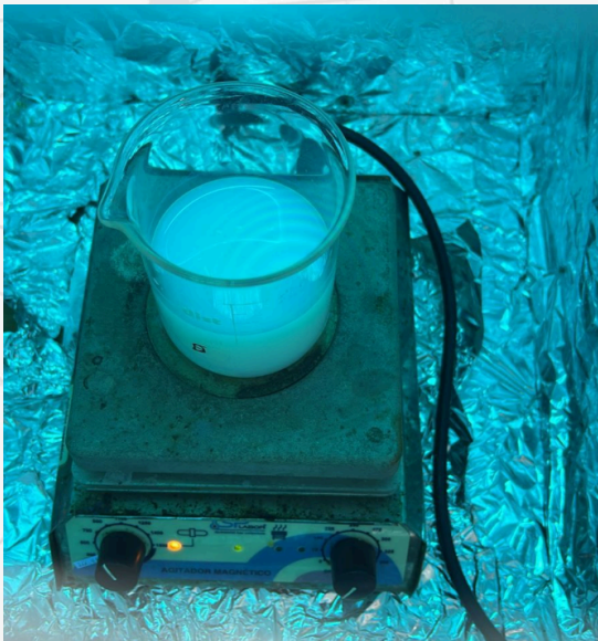
Fotografia 1: Sistema fotocatalítico \text{TiO}_2 /UVC em operação
