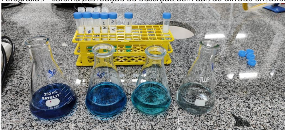
Fotografia 1 - Sistema pós reação de adsorção com carvão ativado em sistema de agitação.
