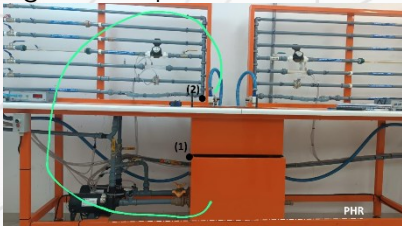
Figura 4 - Experimento de Cálculo da Carga e Potência da Bomba 2
