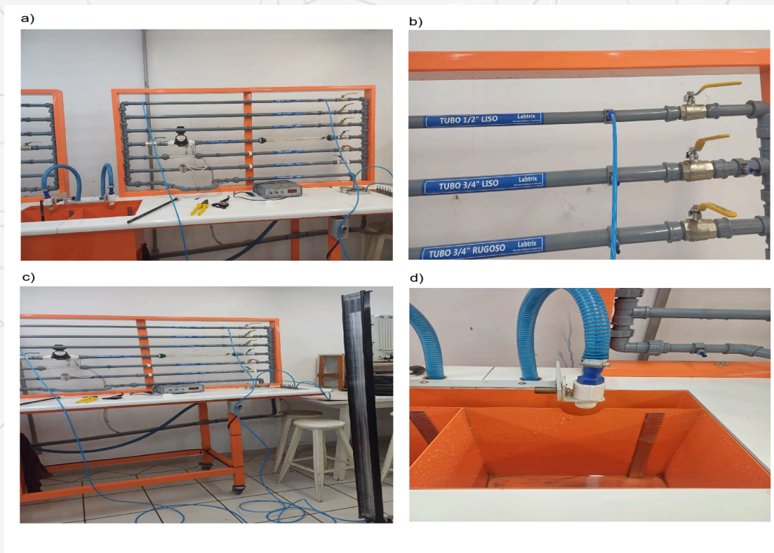
Figura 1 - Unidade experimental (a), tubo 1/2" liso (b), manômetro (c) e reservatório (d)
