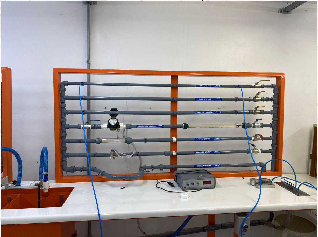
FIGURA 1 - BANCADA EXPERIMENTAL USADA NA DETERMINAÇÃO DE PERDA DE CARGA
