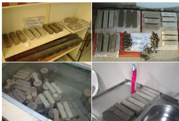
Fotografia 1: Curas realizadas (a) Cura em ambiente coberto; (b) Cura ao ar livre; (c) Cura úmida; (d) Cura em ambiente coberto com aspersão Fonte: as autoras
