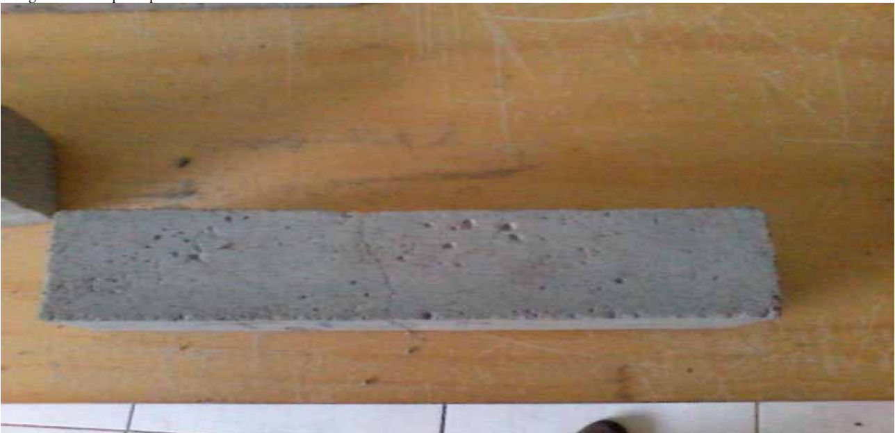
Fotografia 2 – Corpo de prova fissurado
