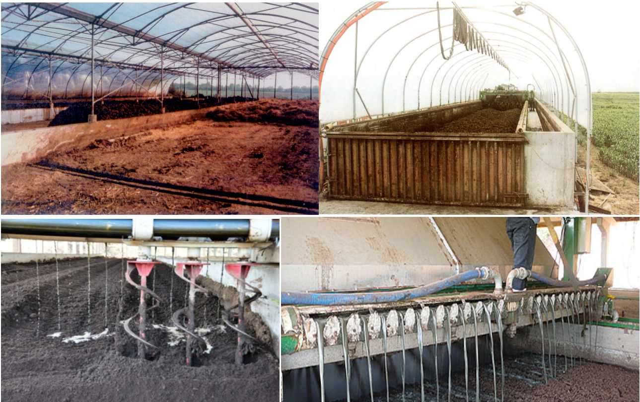
Fotografia 1 – Vista do sistema de tratamento dos dejetos de suínos em plataforma de compostagem, revolvimento com o uso de trator e revolvimento mecânico
