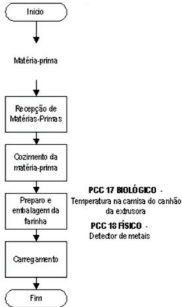
Fluxograma 1 – Processo de obtenção de proteína texturizada de soja
