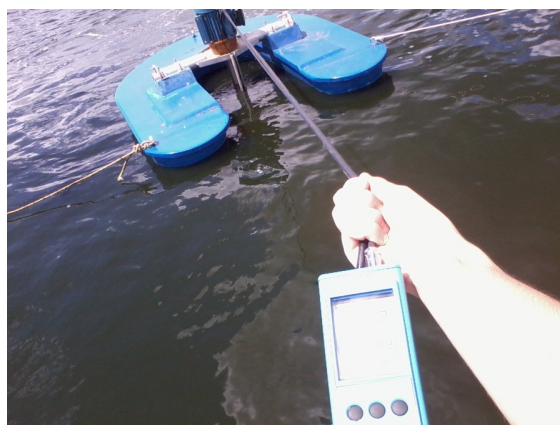
Fotografia 1 – Instalação da sonda do oxímetro a 10 cm da hélice e monitoramento da oxigenação utilizando-se oxímetro
