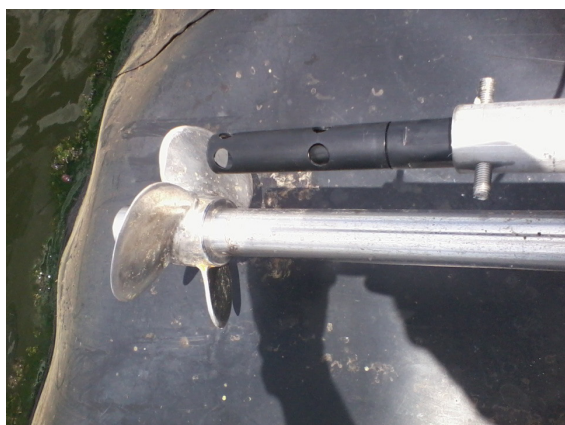
Fotografia 1 – Instalação da sonda do oxímetro a 10 cm da hélice e monitoramento da oxigenação utilizando-se oxímetro
