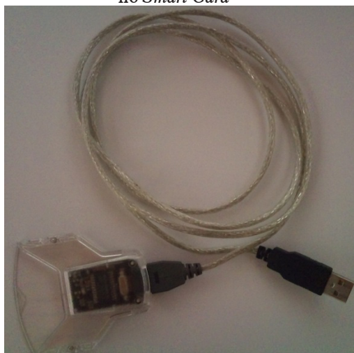
Fotografia 1 – Leitora de cartão Smart Card Gem Pc Twin utilizada para a leitura do software armazenado no Smart Card
