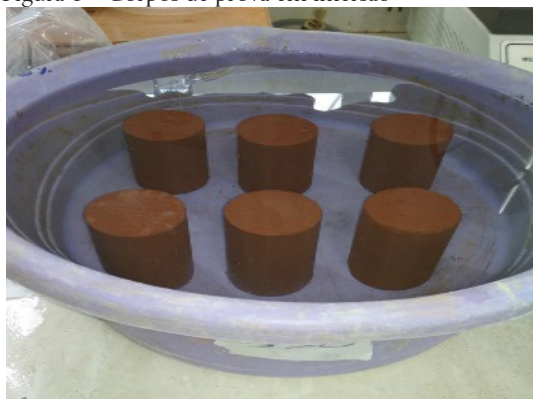
Figura 1 – Corpos de prova em imersão
