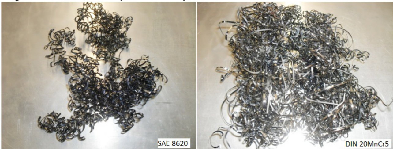
Fotografia 3 – Forma do cavaco do aço SAE 8620 e do aço DIN 20MnCr5
