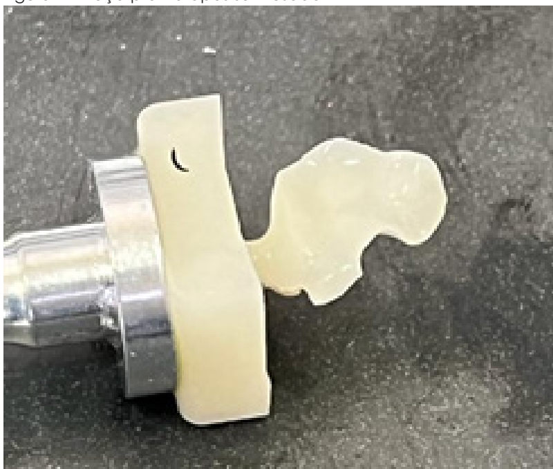
Figura 4 – Peça pronta após ser fresada
