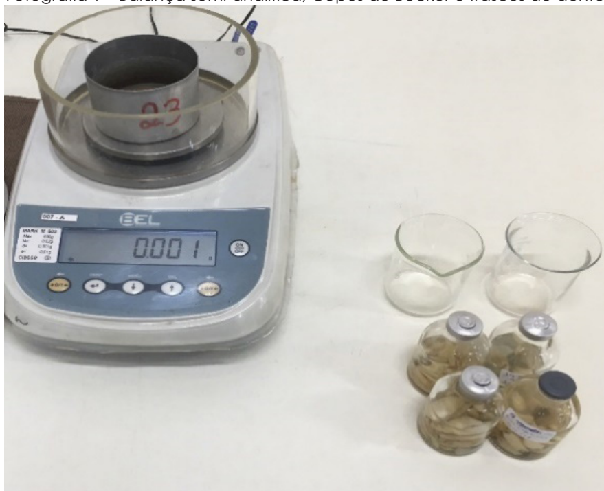
Fotografia 1 – Balança semi-analítica, Copos de Becker e frascos de dentes
